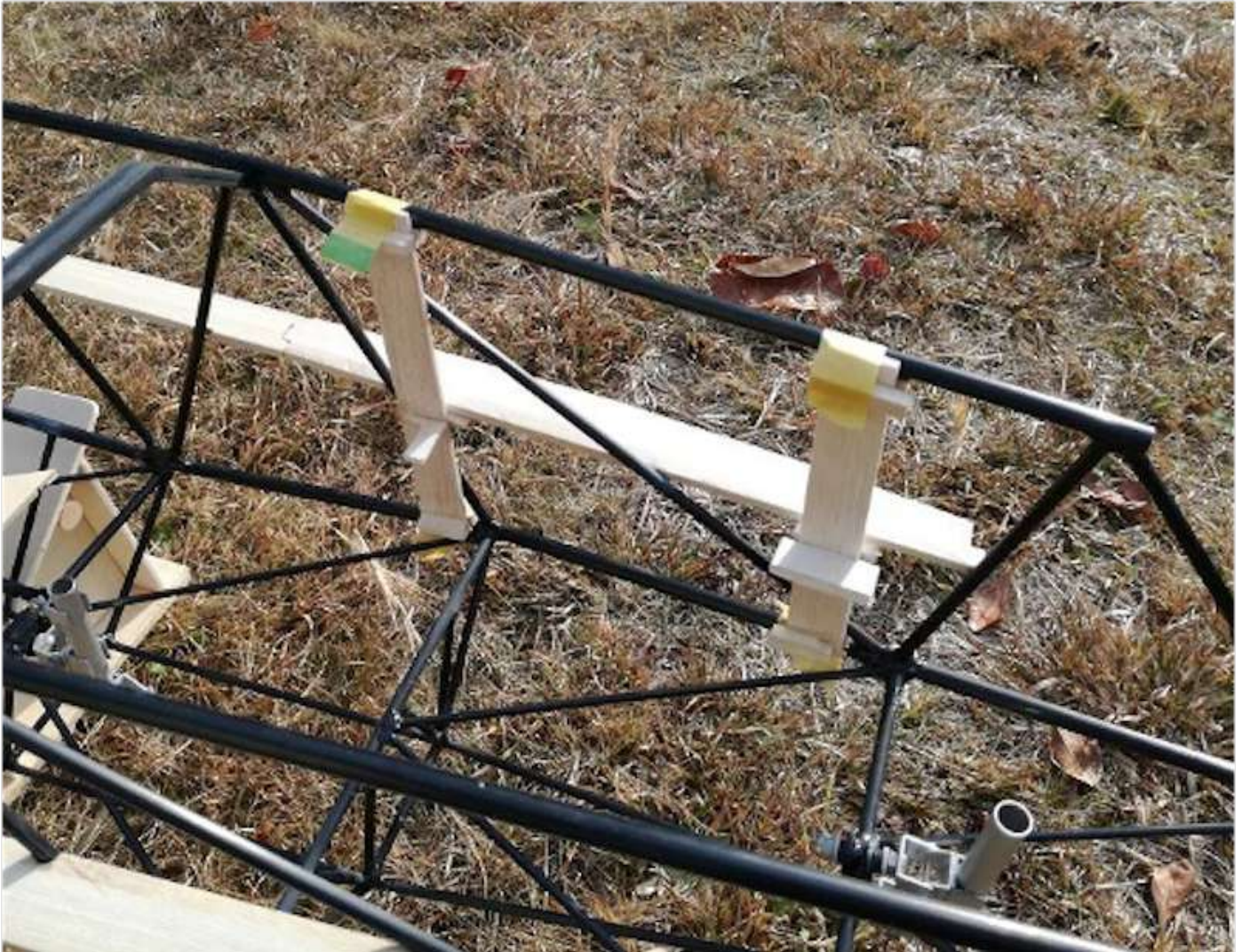
画像119 簡易位置決め治具による側方張出の取付作業状況
