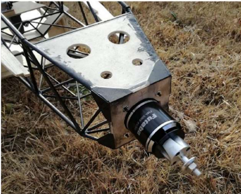
画像127 マウントへのモーター仮取付
