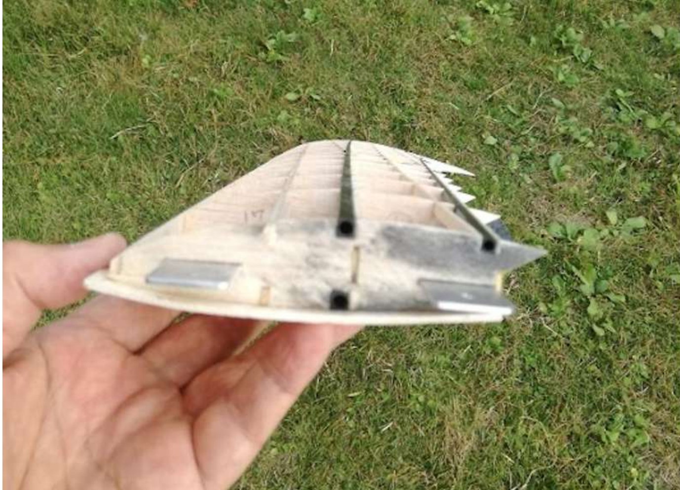
画像103 外翼桁の変形
