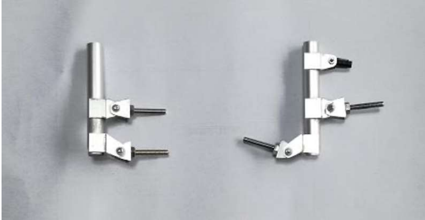
画像87 改修後のジンバル機構
