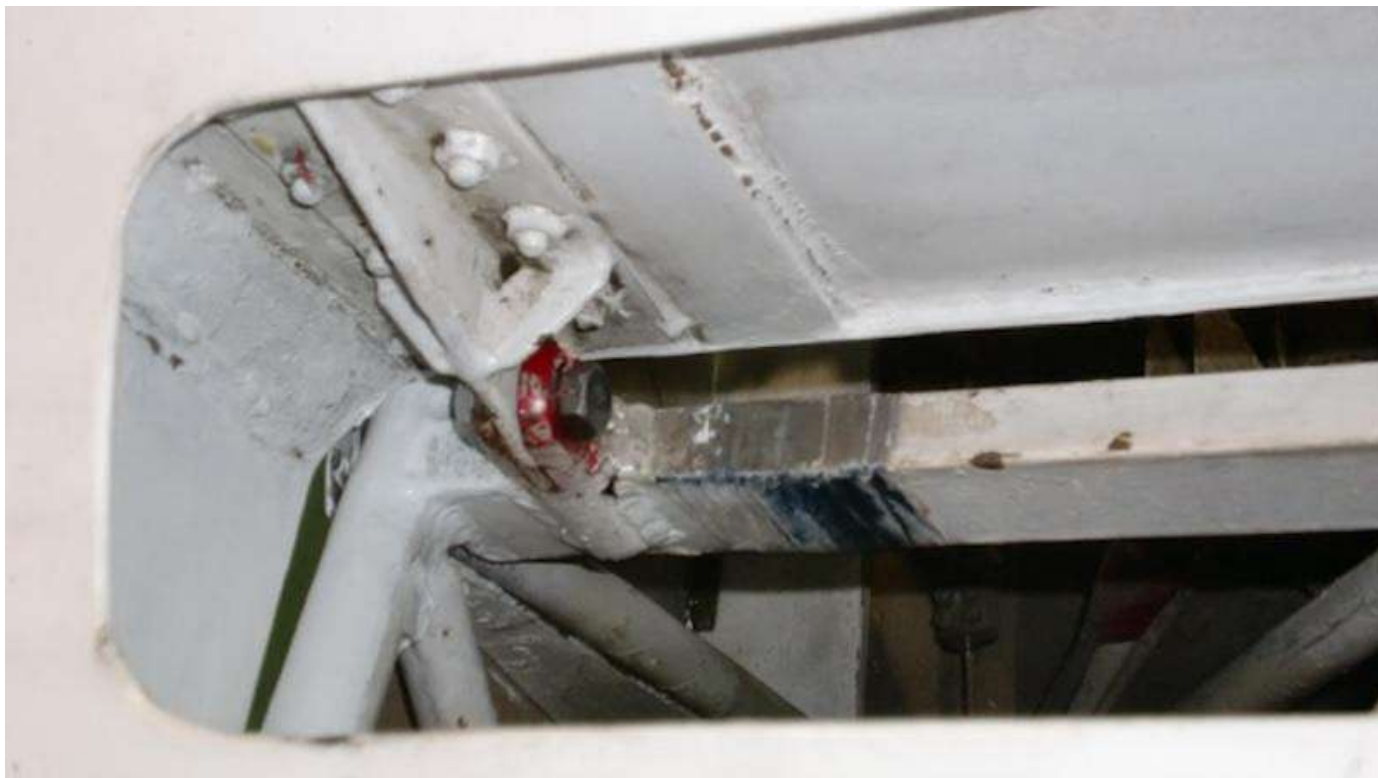
画像95 実機の後桁と胴体の結合金具
