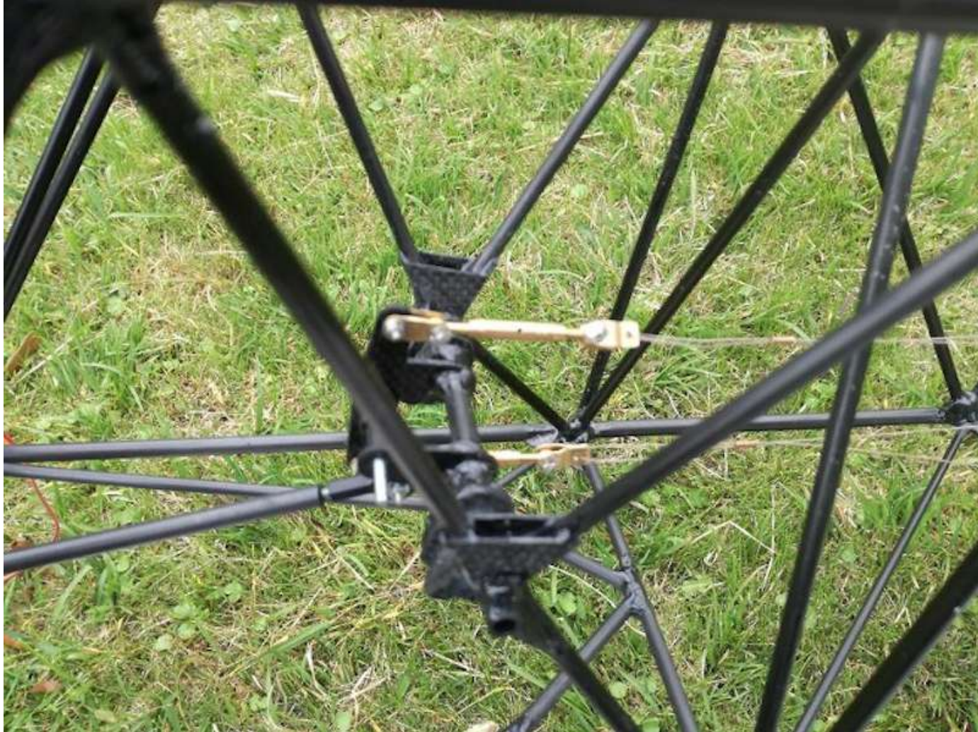
画像89 前側ベルクランク拡大写真
