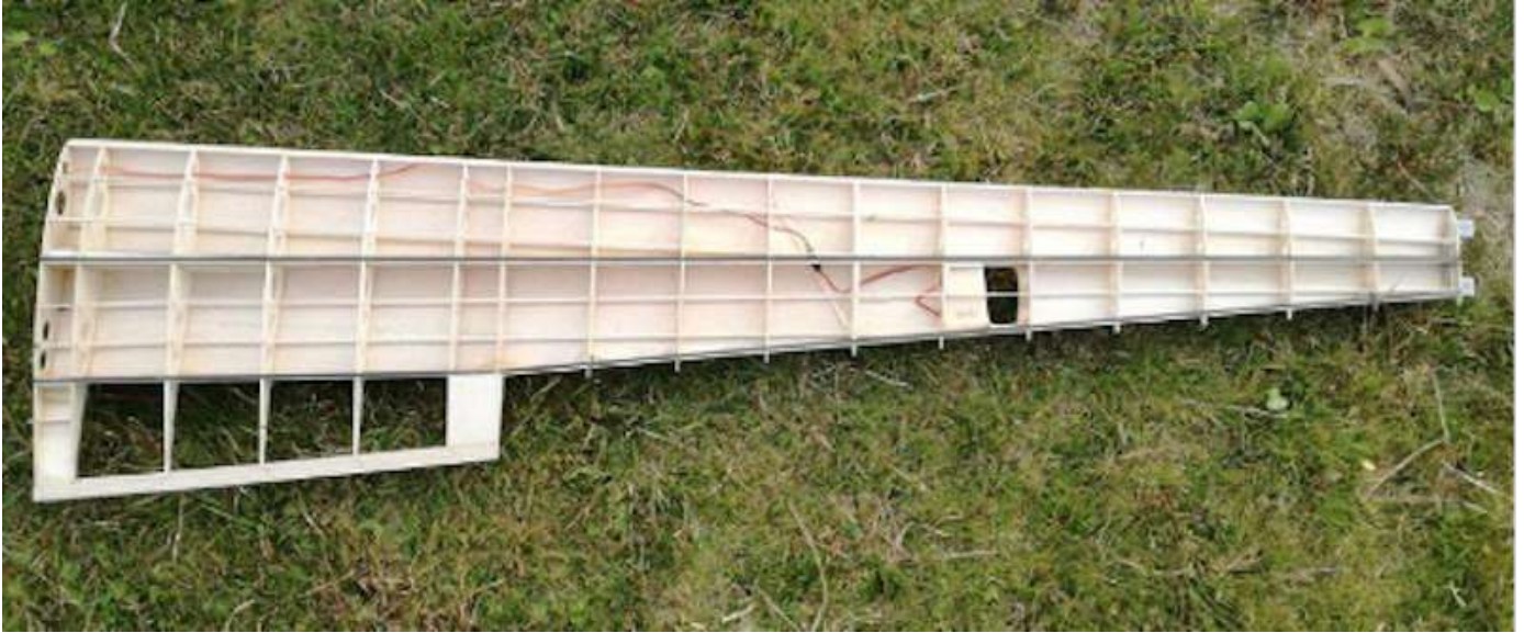
画像106 下側プランクが完了した外翼
